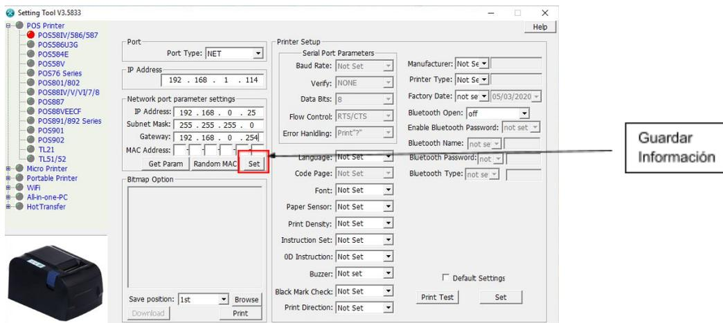
13.- Para comprobar que la impresora cambio de IP apaga la impresora, después oprimiendo el botón con el que sale el papel encienda de nuevo la impresora hasta que salga un Ticket con los datos de la impresora donde se mostrara si se cambió la IP ya que debe aparecer la que colocamos.
