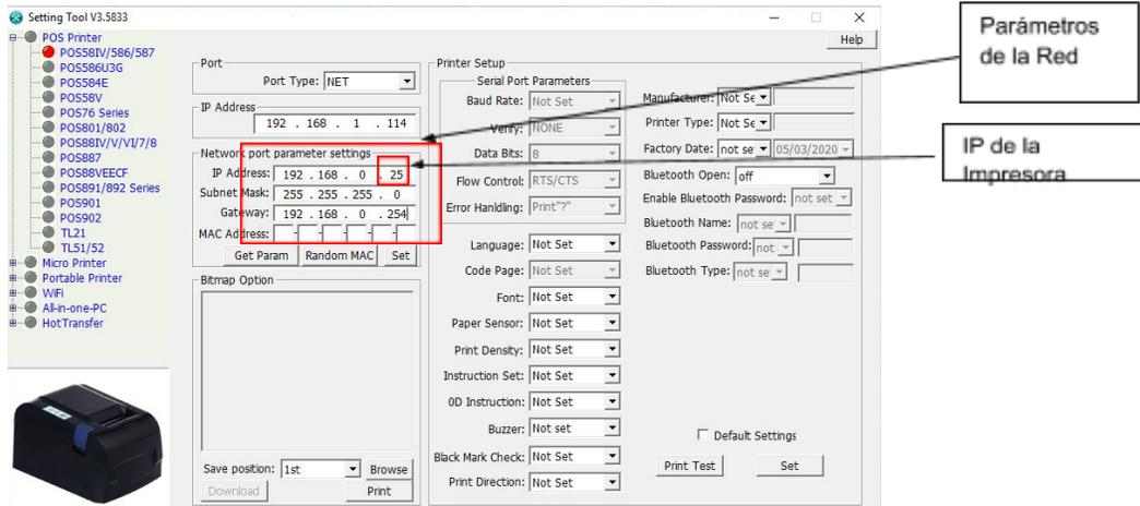
12.- Una vez cambiamos todos los parámetros de la impresora seleccionamos Set para guardar la información dentro de la Impresora
